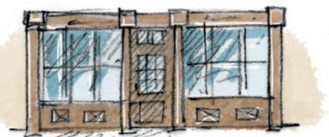
A partir du XIX e siècle, devanture en bois en saillie sur le mur en maçonnerie
