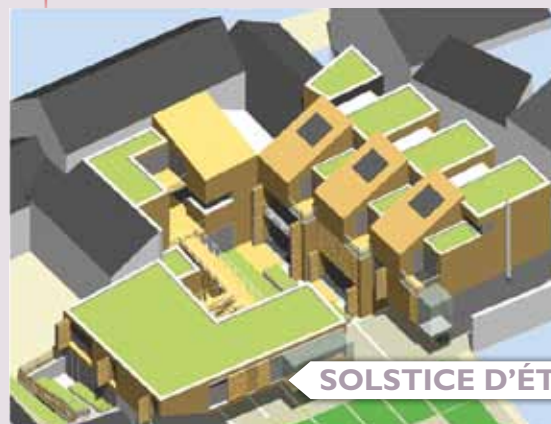
Simulation des ombres portées au cours de l'année à 13h00
